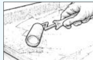
Figur 28 Foretag en overfladebehandling for at fylde vævsstrukturen, før gennemvædningen bliver klæbefri.
